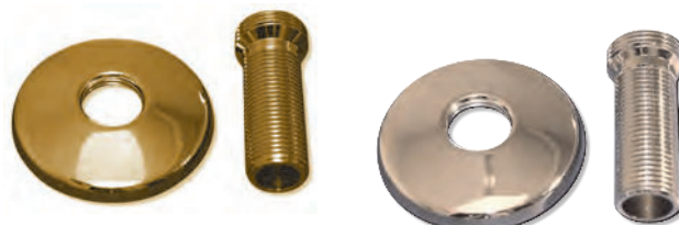
Tilgangsstykke med roset 60 mm LL, 3/4" x 1/2". GDV godkendt 03/00218.
