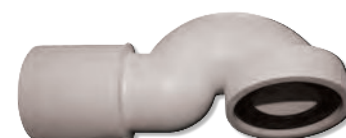
McAlpine CON QP til muffe Bøjning 90°, 110 × 290 mm, forskyder CC med 50 mm bagud mod væg.
