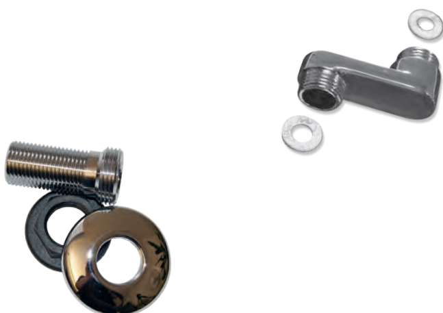
Tilgangsstykke med roset, excentrisk 55 mm forkromet, 3/4" x 1/2" og kontramøtrik.
